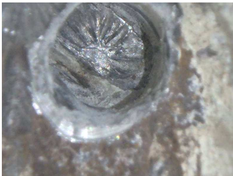
Sonda PV 20 – předpínací dráty bez koroze
