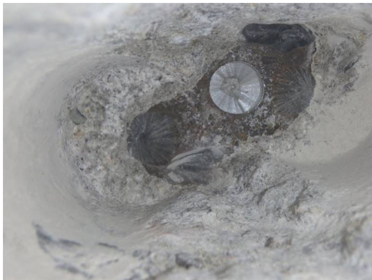
Sonda PV 23 – odvrtání chráničky – kanálek je zainjektovaný
