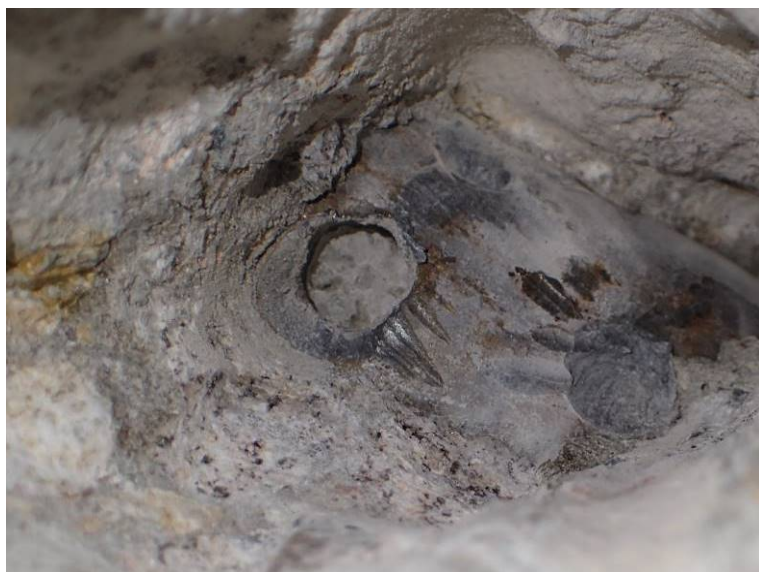
Sonda PV 30 – odvrtání chráničky – kanálek je zainjektovaný
