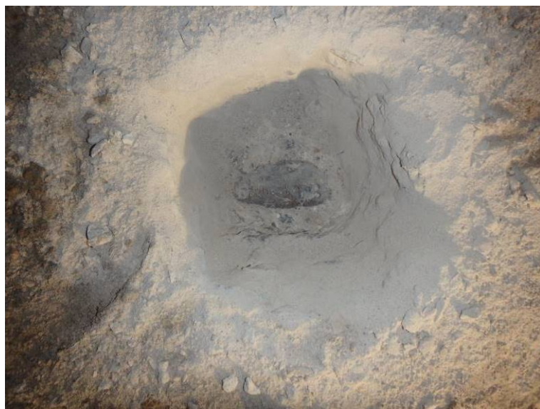
Sonda PV 1 – pohled na sondu s obnaženou tlustostěnnou chráničkou
