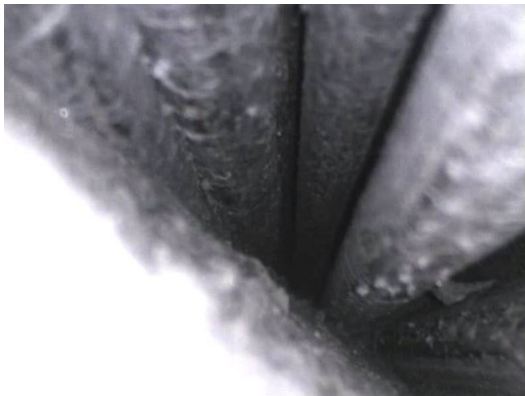
Sonda PVK 6 – pohled endoskopem pod kotvu – na snímku je patrná dutina pod kotvou a předpínací dráty
