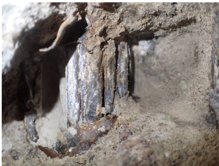
Sonda PV 29 – v místě průsaků, zainjektováno, ale malta mokrá, dráty bez koroze
