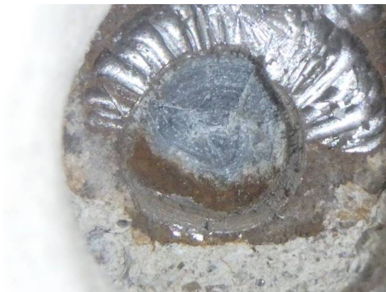
Sonda PV 7 – odvrtání chráničky – kanálek je zainjektovaný
