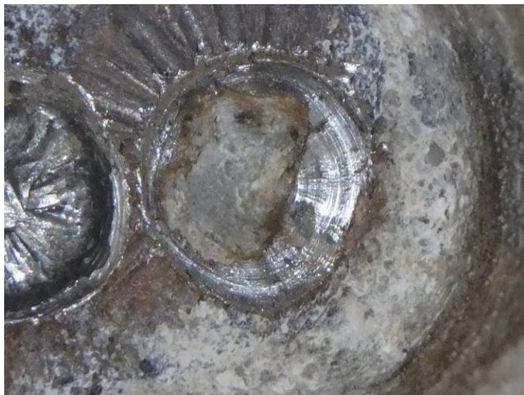
Sonda PV 17 – odvrtání chráničky – kanálek je zainjektovaný
