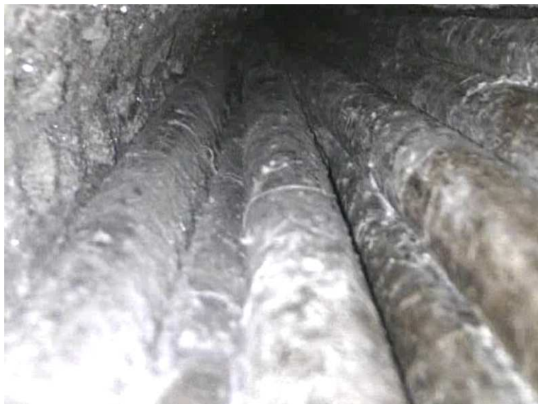
Sonda PVK 1 – pohled endoskopem pod kotvu – detail drátů
