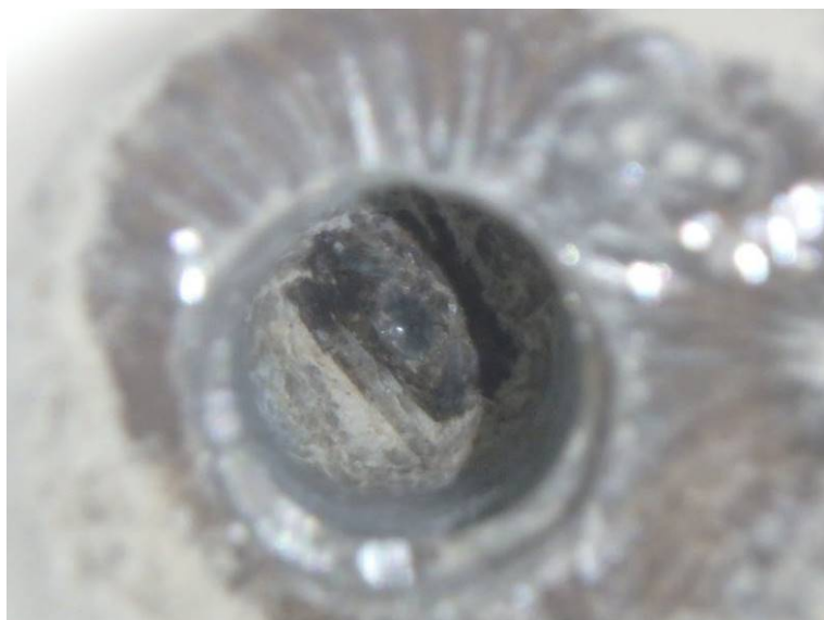
Sonda PV 12 – předpínací dráty bez koroze
