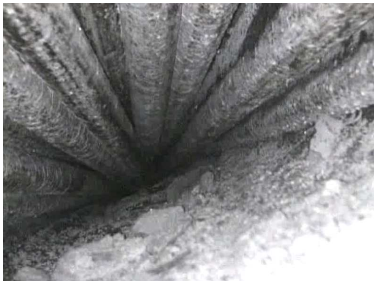
Sonda PVK 7 – pohled endoskopem pod kotvu – na snímku je patrná sedlá hladina injektážní malty a volné dráty nad touto hladinou
