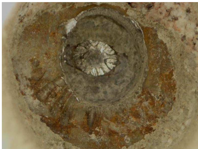
Sonda PV 32 – předpínací dráty bez koroze
