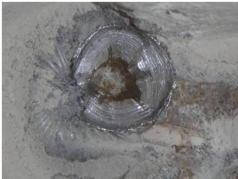
Sonda PV 15 – odvrtání chráničky – kanálek je zainjektovaný
