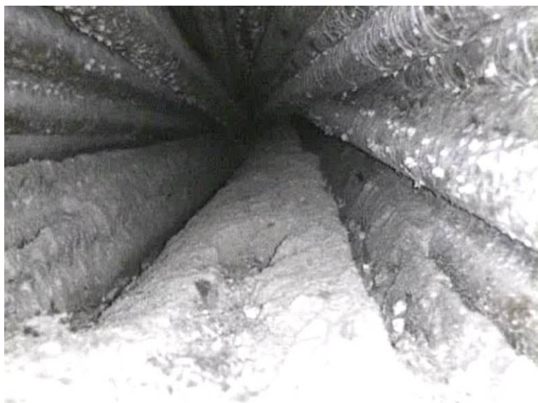
Sonda PVK 4 – pohled endoskopem pod kotvu – na snímku je patrná dutina pod kotvou a předpínací dráty
