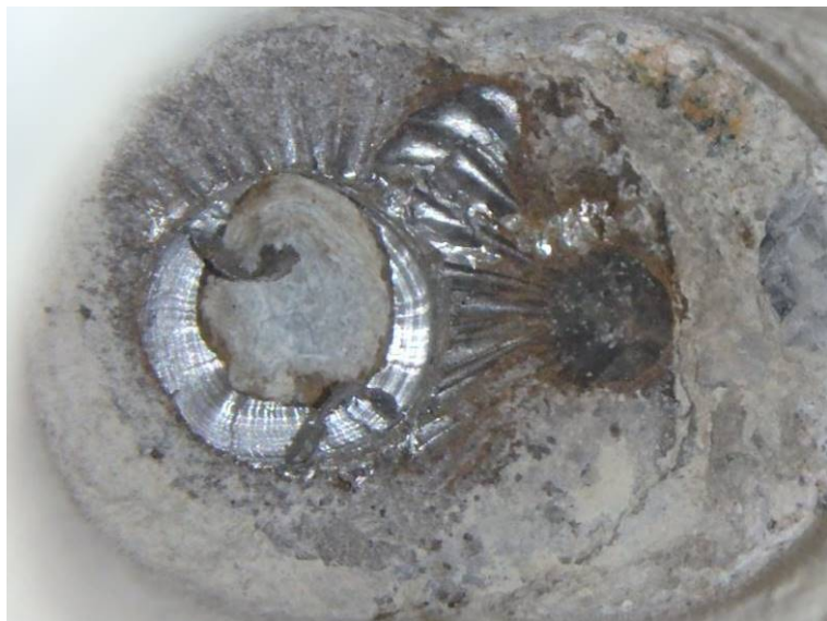
Sonda PV 12 – odvrtání chráničky – kanálek je zainjektovaný
