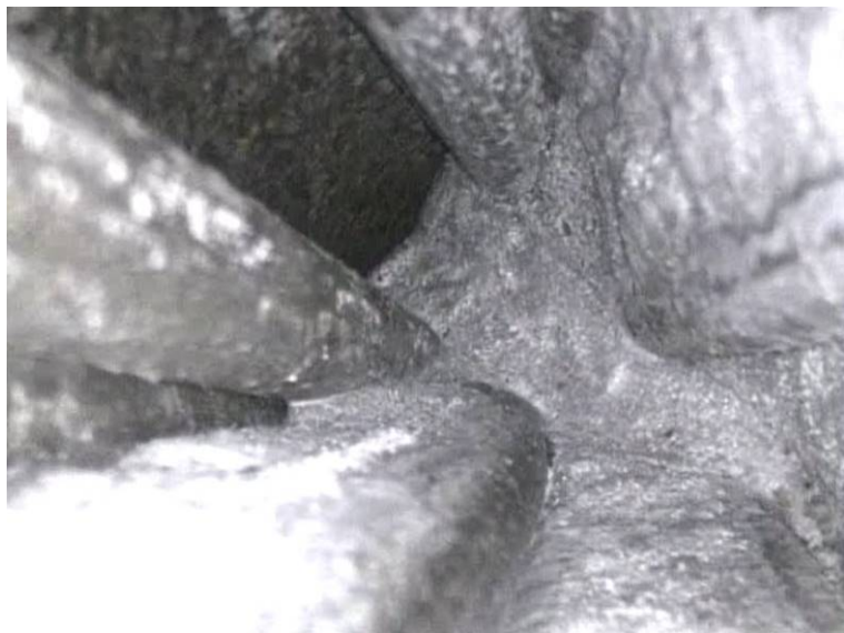
Sonda PVK 8 – detail sedlé injektážní malty
