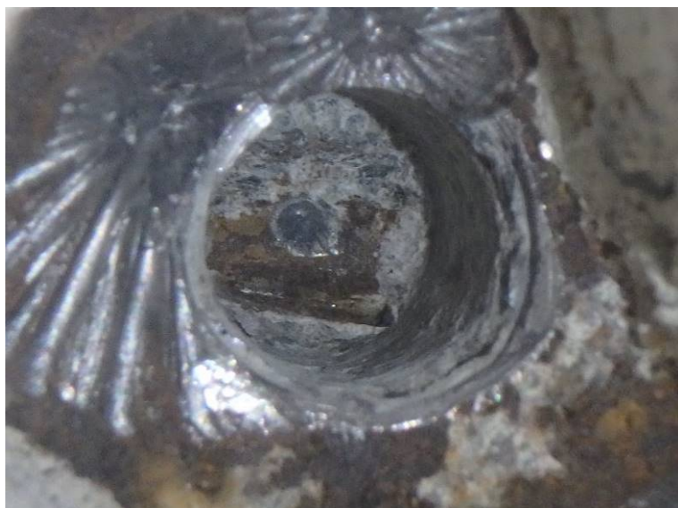
Sonda PV 6 – předpínací dráty bez koroze
