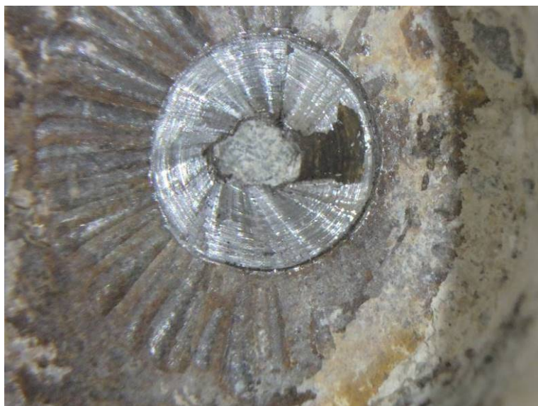
Sonda PV 5 – odvrtání chráničky – kanálek je zainjektovaný
