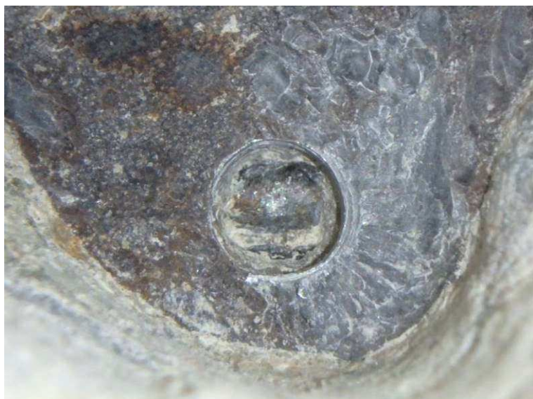
Sonda PV 2 – odvrtání chráničky – kanálek je plně zainjektovaný, dráty bez koroze
