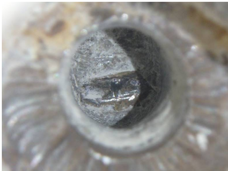
Sonda PV 5 – předpínací dráty bez koroze
