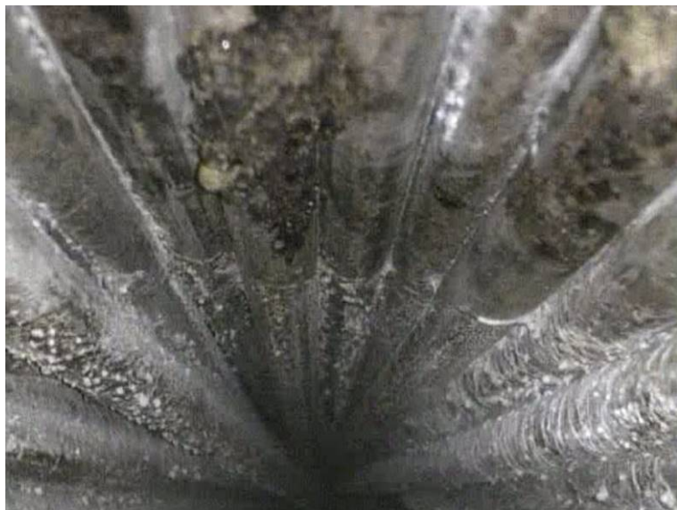
Sonda PVK 4 – pohled endoskopem pod kotvu – detail drátů
