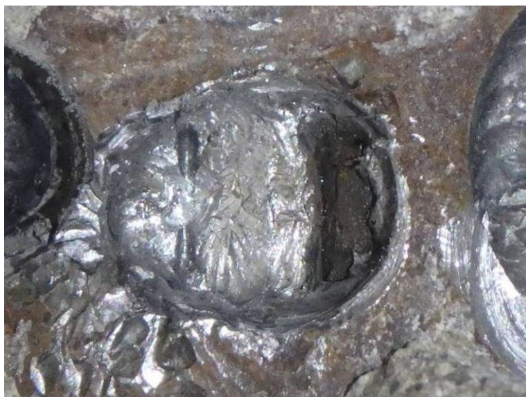
Sonda PV 14 – odvrtání chráničky – kanálek je zainjektovaný, dráty jsou bez koroze, ale vykazují tmavý povlak.
