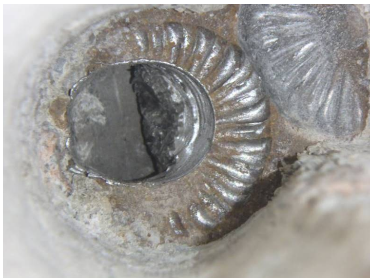
Sonda PV 27, dutina v kanálku, suchá
