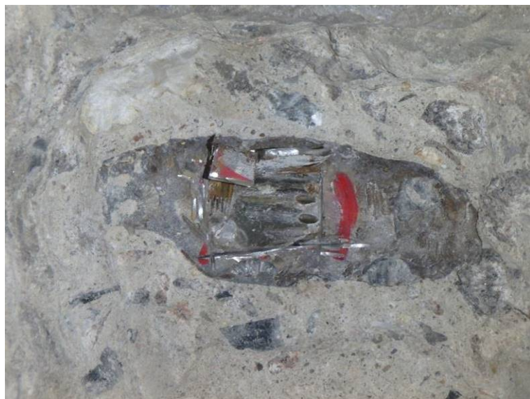
Sonda PV 1 – otevření chráničky – kanálek je plně zainjektovaný
