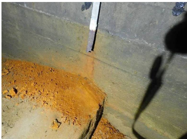
Rozpadlý uzemňovací pásek
